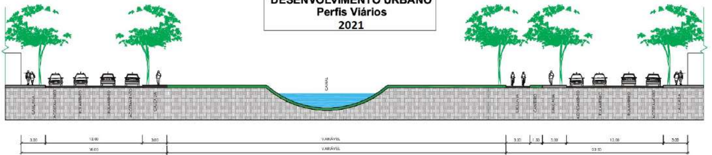
VIA COLETORA III COM CANAL
