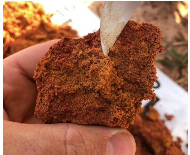
Foto 2-31 - Fragmentos de couraça entre agregados de solo - Coordenadas UTM - 24L - 711.128 mE, 8.787.650 mN
