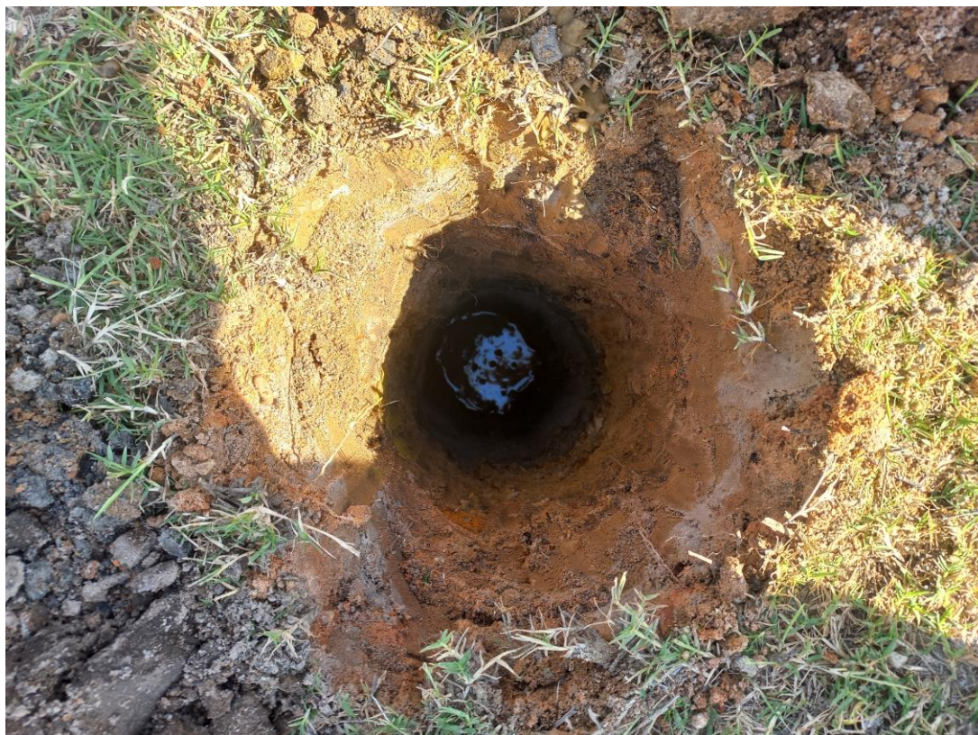
Furo de sondagem 43 – Presença de água.
